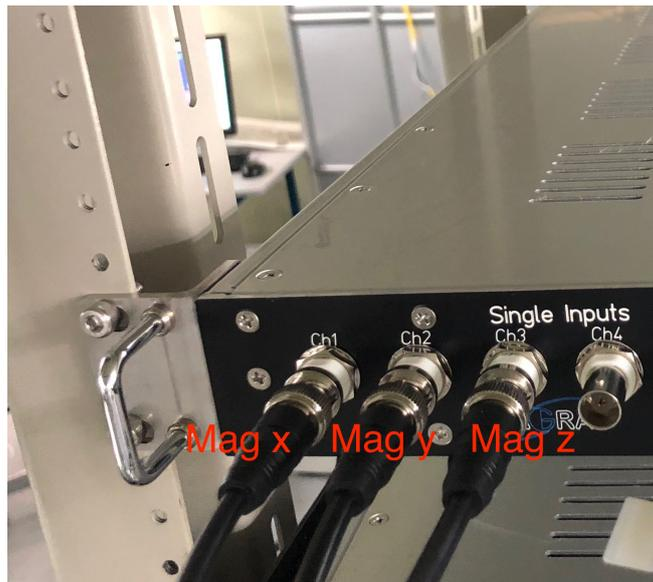
図 8 BNC-Dsub Converter への接続
