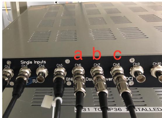
図5 BNC-Dsub Converter への接続
