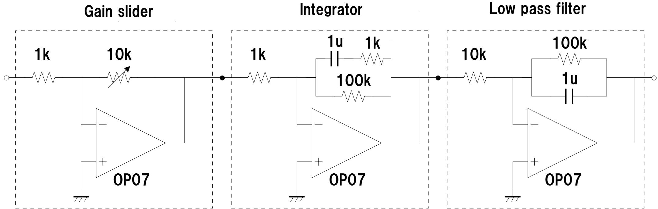
Fig.D.1.3 光軸制御で使用したループフィルターの回路図
